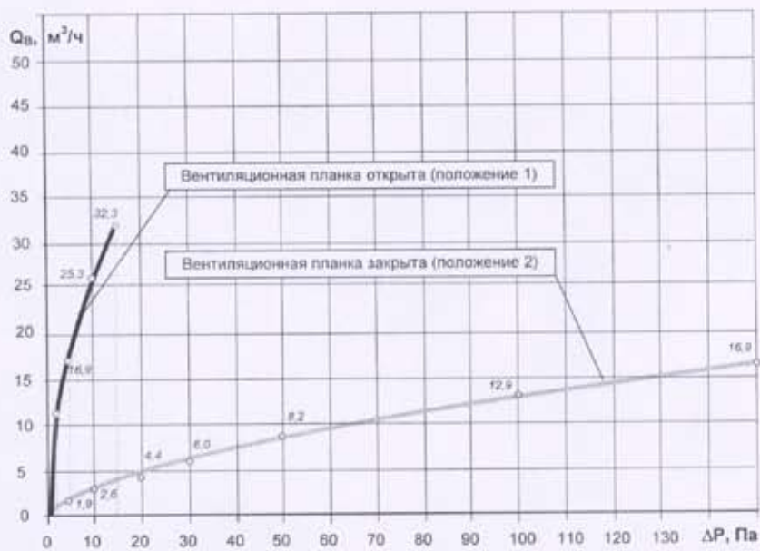
Рис.1. Результаты испытаний гигрорегулируемых оконных приточных устройств модели EMM 3-30 ТУ 4863-001-55227127-03 по показателю расход воздуха при открытом и закрытом положении вентиляционной планки
